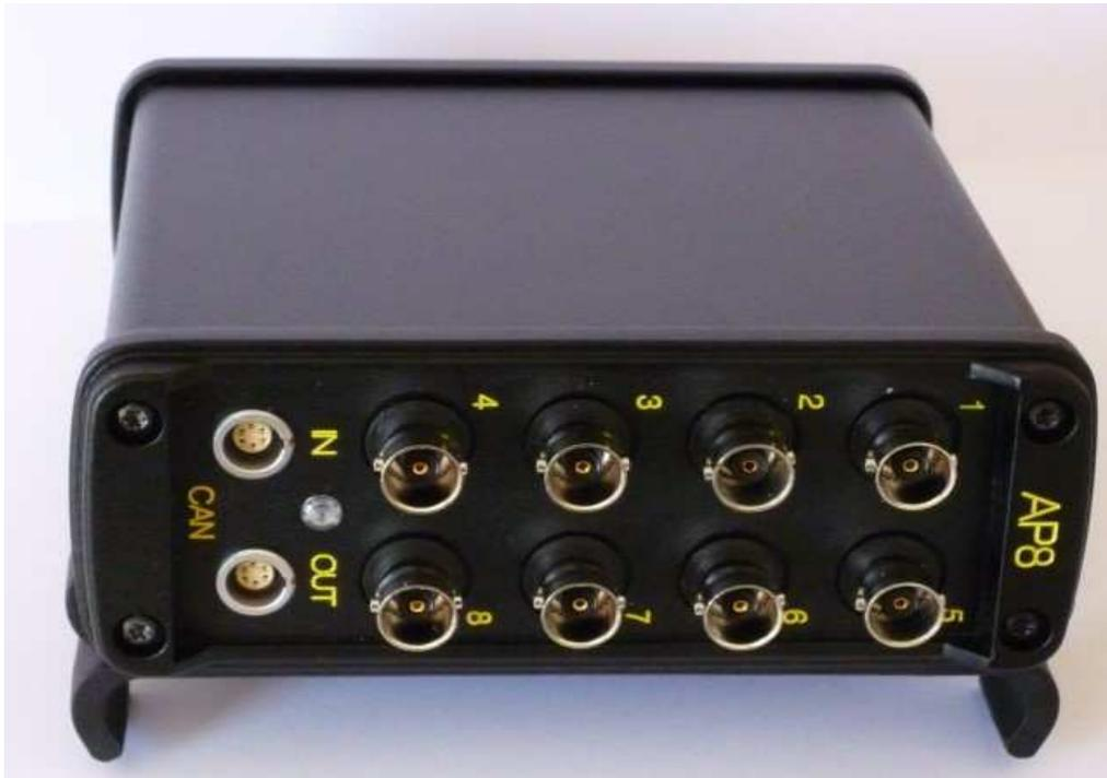
**Abbildung A2:** Modul DIGOUT, Ausführung: BNC Buchsen
